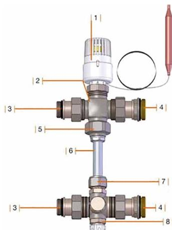
1. Термостатическая головка с капиллярным датчиком
