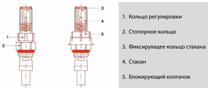
Общие потери напора в отопительном контуре складываются из локальных потерь: расходомера на подаче, труб и терmostатического клапана.
