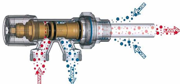
В вентилях серии M 88 в положении закрыто 100% потока контура уходит через байпас, при этом на данный отопительный прибор теплоноситель не поступает.
