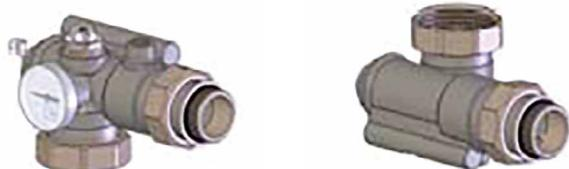
предназначен для поддержания температуры теплоносителя в системе напольного отопления с фиксированным температурным режимом. Применяется в смесительных системах отопления, которые имеют высокотемпературный контур (радиаторный) с температурой теплоносителя от  $\geq 70^{\circ}\text{C}$ , и низкотемпературный (напольное отопление) от  $20^{\circ}\text{C}$  до  $50^{\circ}\text{C}$ .
