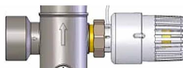
Теплоноситель из вторичного контура возвращается в первичный контур, проходя через балансировочный клапан, с помощью которого возможно произвести гидравлическую связь потерь давления между первичным и вторичным контурами.
