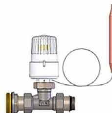
Этот клапан управляет терmostатической головкой с капиллярным датчиком, который поддерживает заданную температуру на коллекторе подачи контура теплого пола, смешивая теплоноситель, поступающий из высокотемпературного контура с теплоносителем, циркулирующим в системе напольного отопления.
