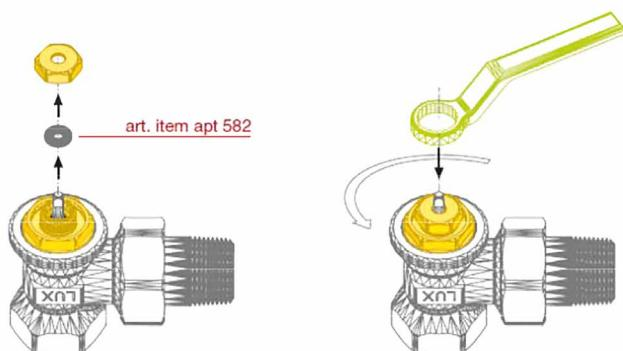
Шток управления выполнен из нержавеющей стали AISI 316. Герметичность штока обеспечивается за счет пары уплотнительных прокладок o-ring из EPDM пероксидной полимеризации, а герметичность шпинделя обеспечивает 1 кольцевая прокладка o-ring из EPDM пероксидной полимеризации. Запорная прокладка на затворе
