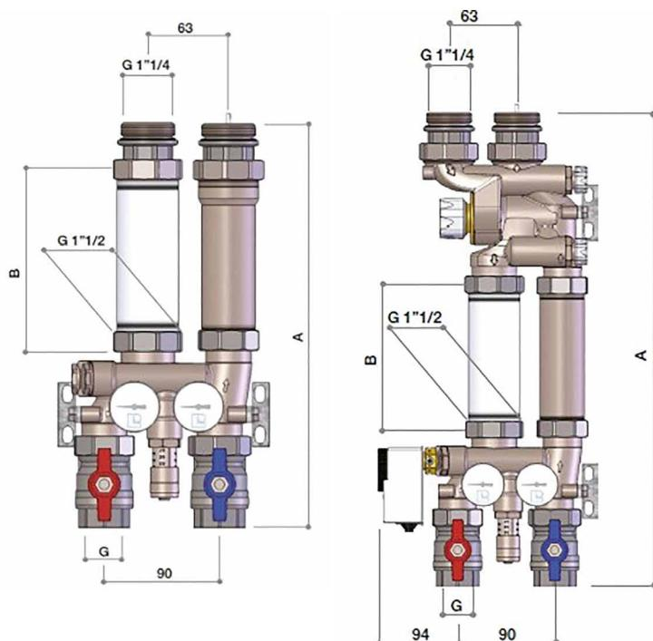
Коллектор CD 1210 в случае сборки в одном направлении имеет такой же гидравлический режим работы как классический компланарный коллектор.
