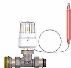
Этот клапан управляется терmostатической головкой с капиллярным датчиком, который поддерживает заданную температуру на коллекторе подачи контура теплого пола, смешивая теплоноситель, поступающий из высокотемпературного контура с теплоносителем, циркулирующим в системе напольного отопления.
