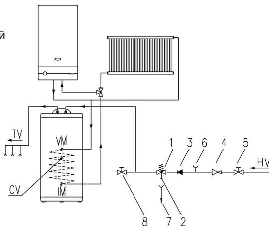
Нагреватель может подключаться к водопроводной сети в доме без редукционного клапана, если давление в ней ниже 0,6 МПа (6 бар). Если давление превышает 0,6 МПа, то требуется встроить редукционный клапан.
